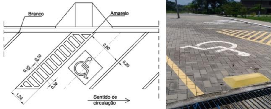
Figura 8 - Sinalização horizontal de vagas.
